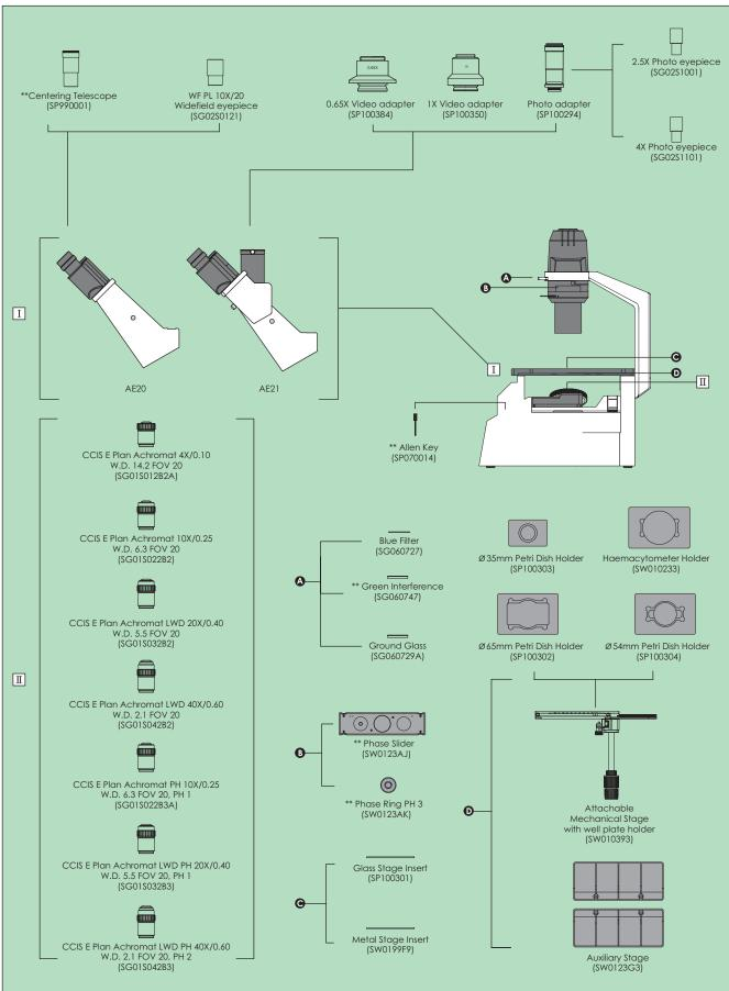
MOTIC INVERTED MICROSCOPE AE20/21 SYSTEM DIAGRAM
