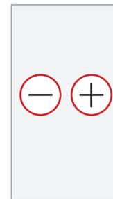
Gradateur de régulation de la lumière réfléchie et de la lumière transmise. Si la lumière réfléchie et la lumière transmise sont allumées simultanément, le réglage de la luminosité est synchrone.
