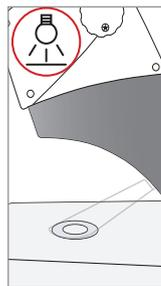
3 pressions : deux diodes : éclairage rasant pour mettre en valeur la structure des surfaces et du contraste avec les objets plats
