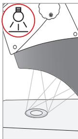
1 pression : cinq diodes : luminosité maximale pour les objets en lumière réfléchie
