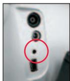
Avec une pointe de stylo, appuyer sur le petit bouton situé sur le panneau arrière au voisinage des connecteurs afin de commuter de PAL (Europe) à NTSC (États-Unis, Canada)
