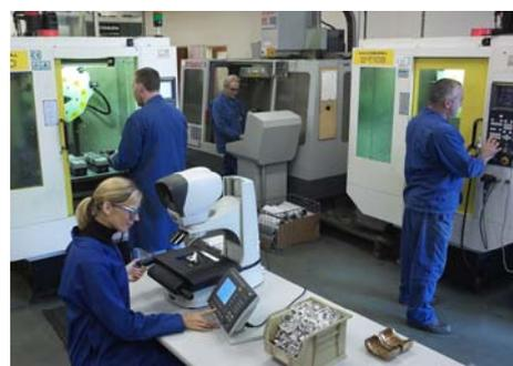
Für genaue Messungen sind klar ersichtliche, scharfe Bilder erforderlich. Das berührungslose 3-Achsen Messsystem Hawk unterstützt Sie bei hochgenauen, wiederholbaren Messungen von komplexen Werkstücken aller Materialien und bietet Ihnen somit eine modulare und flexible Lösung für Ihre spezifischen Messaufgaben.
