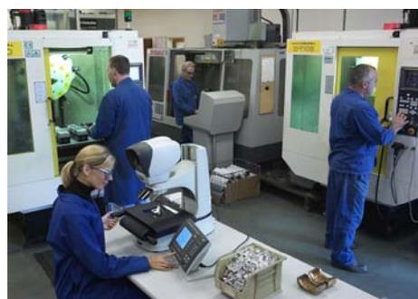
Pour des mesures précises, il est primordial d'avoir des images claires et à haute définition. Le système de mesure Hawk 3 axes sans contact, donne des mesures répétables de haute précision pour la fabrication de pièces complexes en matériaux variés, offrant une solution modulaire et flexible répondant à un large éventail d'exigences de mesure.
