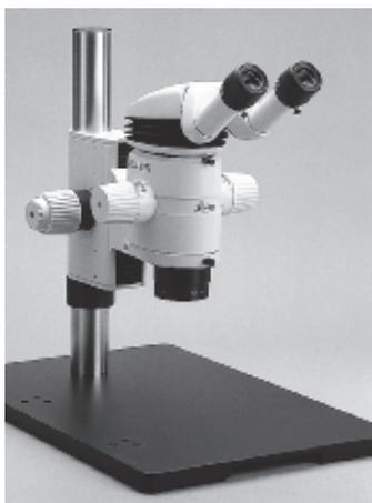
Boîte de commande avec réglage approximatif/précis, réf. 10 447 082, sur statif universel
