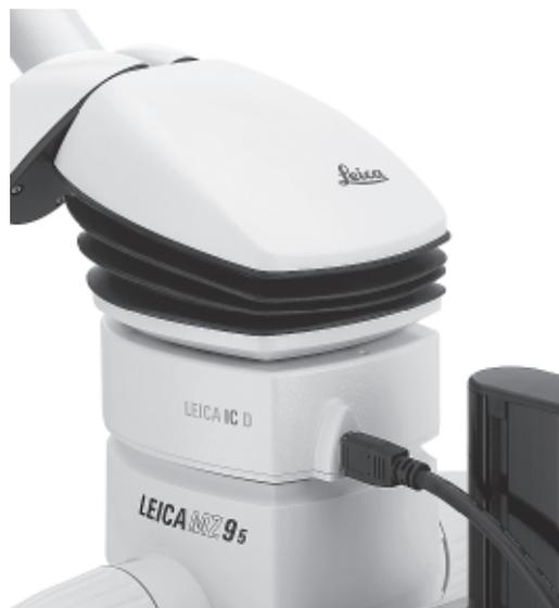
Connexion au moyen d'un unique câble FireWire
