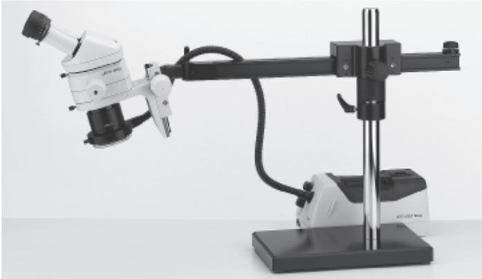
Statif à bras mobile standard avec Leica MS5 et commande de mise au point inclinable (10 447 254), porte-microscope intégré
