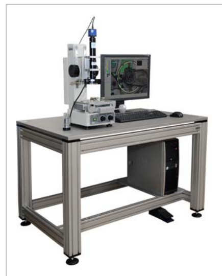
MM200 mit Zoom 12x, Digitalkamera und CAD-Metreo Vergleichssoftware sowie massiven Ryf Standard Alutisch
