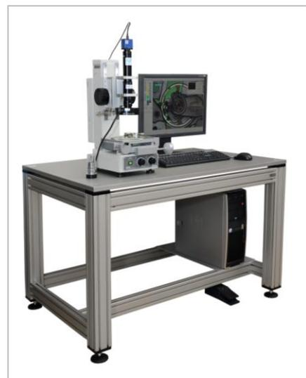
MM-200 avec zoom 12x, camera numérique et logiciel CAD-Metreo de comparaison sur table Ryf standard.
