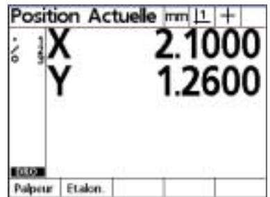
Lorsque la fonction **Alignement** a été utilisée pour dégauchir une pièce, un petit rectangle incliné apparaît sur la droite de chaque lettre correspondant aux axes. Les attributions des touches menu peuvent ou ne pas apparaître en bas de l'écran.
