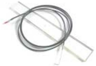
Le cas échéant, nettoyez soigneusement l'extrémité du détecteur avec un chiffon doux non pelucheux.
