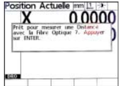
Procédez à la mesure de la cale étalon. Les résultats de la mesure seront comparés à la valeur nominale de l'étalon. Si la mesure ne se rapproche pas suffisamment de l'étalon, un message vous demandera d'appuyer sur la touche **Enter** pour effectuer une nouvelle mesure.
