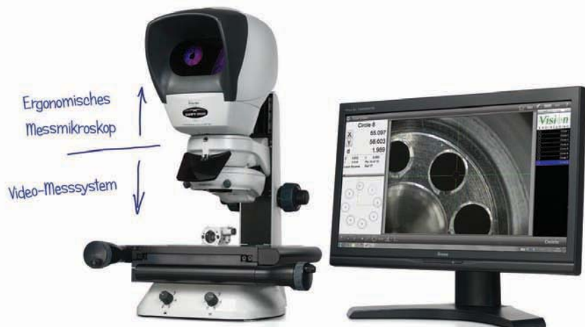
Sichtfeldmessungen mit dem digitalen Messmikroskop Xpress.
