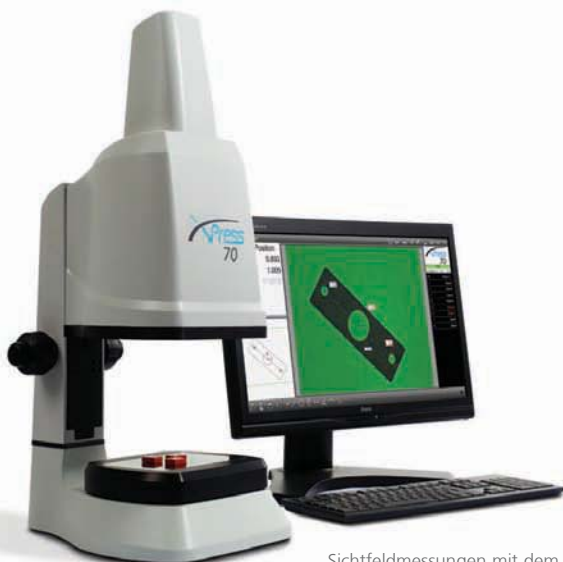
Sichtfeldmessungen mit dem digitalen Messmikroskop Xpress.
