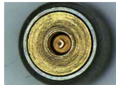
Échantillon en métal avec éclairage coaxial
