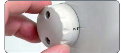
2. Drehen Sie an beiden Okularen die Dioptrienkorrektur in die Mittelposition.
