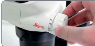
3. Stellen Sie den Anschlag am linken Triebknopf nach vorne, bis er den eingebauten Zoomanschlag berührt.
