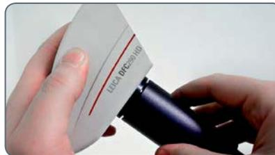
3. Setzen Sie die Einheit in den Video-/Fotoausgang des Stereomikroskops und verschrauben sie.
