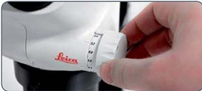
3. Stellen Sie den Anschlag am rechten Triebknopf nach hinten, bis er den eingebauten Zoomanschlag berührt.
