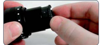
5. Setzen Sie das Okular im Tubusrohr ein und richten Sie die Strichplatte durch Drehen des Okulars im Tubusrohr aus.
