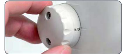
2. Drehen Sie am verstellbaren Okular die Dioptrienkorrektur in die Mittelposition.
