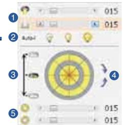
L'éclairage par les 8 zones intérieures de la couronne à LED peut s'incliner de 37 degrés par rapport à l'axe optique et l'éclairage par les 8 zones extérieures de la couronne à LED peut s'incliner de 55 et 78 degrés, ce qui permet de mieux définir les bords qui sont quasiment invisibles avec la lumière coaxiale par le haut.
