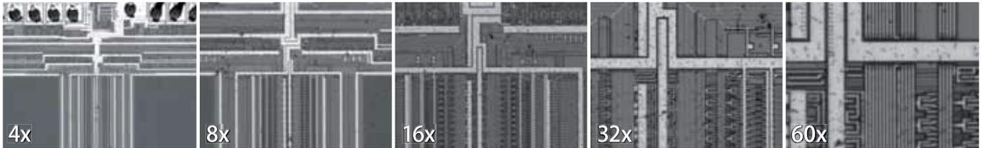
Le type 4, avec un grossissement optique allant de 4 à 60x, soit deux fois le grossissement du type 3, est conçu pour les entités minuscules des pièces très denses. Cet objectif a été conçu récemment, avec une grande Ouverture Numérique de 0,46 et une grande distance de travail de 30mm.
