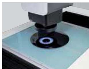
Mesure d'une galette de silicium de 300 mm
