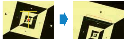
Mit der Suchfunktion können falsch positionierte Bilder erkannt und das Programm passend gedreht werden. Die nächste Messung kann dann mit geneigten XY-Achsen ausgeführt werden.
