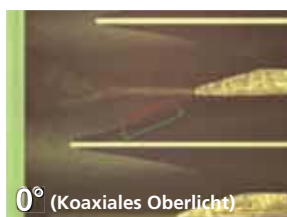
• Koaxiales Auflicht/37 Grad-Neigungswinkel (Anschluss in 5-facher optischer Vergrößerung) Dunkle Kanten werden mit LED-Ringbeleuchtung unter koaxialem Oberlicht sichtbar.
