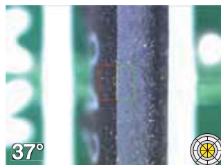
• Koaxiales Auflicht/37 Grad-Neigungswinkel (Anschluss in 5-facher optischer Vergrößerung) Dunkle Kanten werden mit LED-Ringbeleuchtung unter koaxialem Oberlicht sichtbar.
