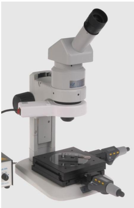
RMM28 avec table de précision x-y 50x50mm et des tambours Tesa numériques à 30mm
