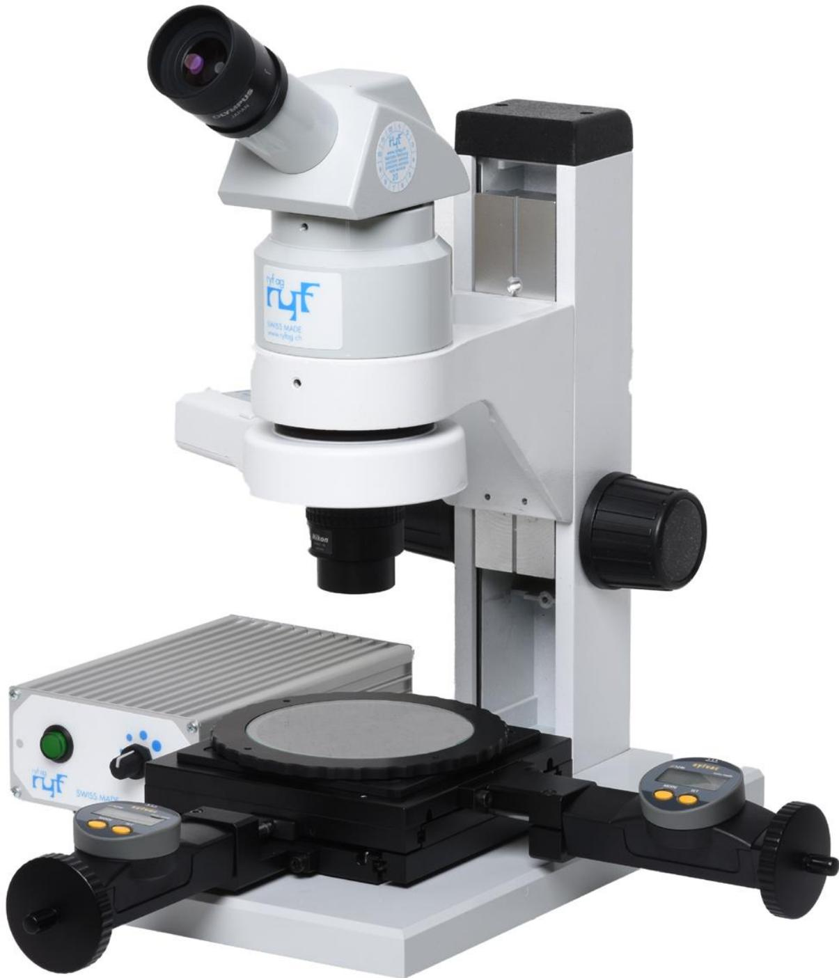
RMM28 avec platine x-y 50x 50mm avec table tournante 360°, des tambours numériques Sylvac 0-50mm et en option oculaire goniomètre optique pour mesurer les angles /10 minutes
