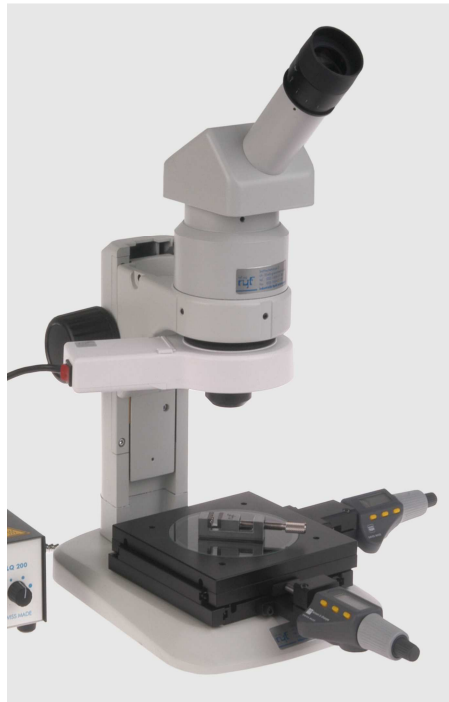
RMM28 mit Präzisionstisch X-/Y-50x50mm, Digital-Messspindel Tesa 0-30mm, Auf- und LED Durchlicht, Okulra mit fixem Fadenkreuz
