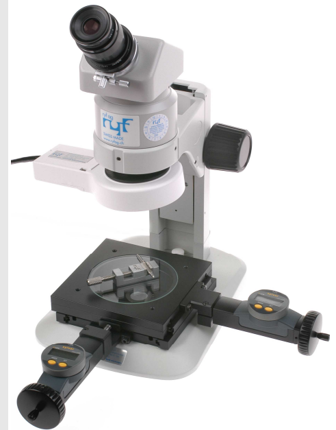
RMM28 mit Präzisionstisch X-/Y-50x50mm, Digital-Messspindel Sylvac 0-50mm, Auf- und LED Durchlicht sowie Gonimeter Okular für Winkelmessungen.
