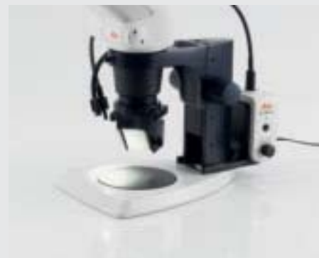
Ansatz für Auf-/Schrägsicht: Rundumsicht ohne Kippen und Drehen des Objekts
