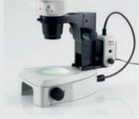
Base de diascopie et fibres optiques universelles pour éclairage diascopique oblique
