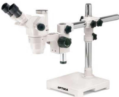
SZ-STL1 Einfaches überhängendes Stativ mit Kopfhalter. 230X230mm Fuß, Ø32x380mm Säule, 430mm horizontaler Arm.
