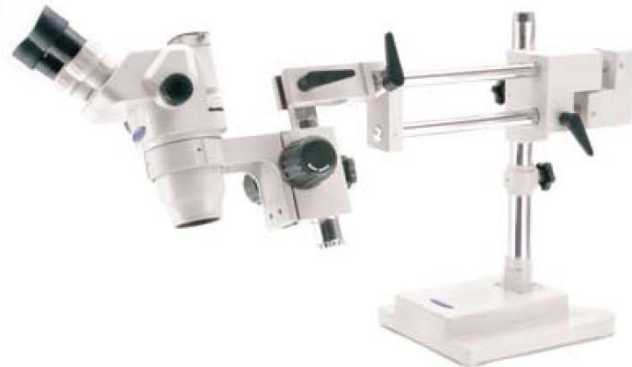
SZ-STL2 Drehbares überhängendes Stativ mit Kopfhalter. 260X210mm Fuß, Ø32x380mm Säule, 550mm horizontaler Arm.
