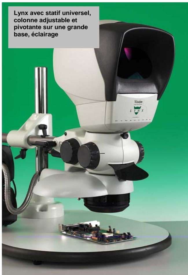
Lynx avec statif universel, colonne ajustable et pivotante sur une grande base, éclairage
