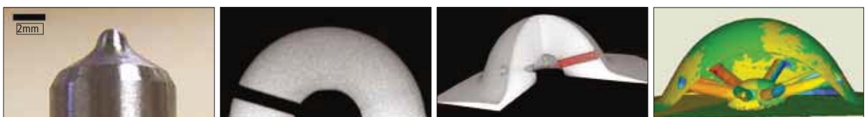
Reconstruction et analyse par TN d'une pièce d'un injecteur de moteur diesel
