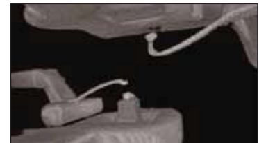
Soudure de fil abimée dans un circuit intégré
