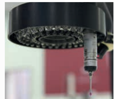
Une option précieuse pour le modèle WM1 CNC : palpeur tactile TP200.
