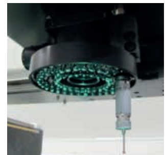
Une option précieuse : palpeur tactile TP200 .
