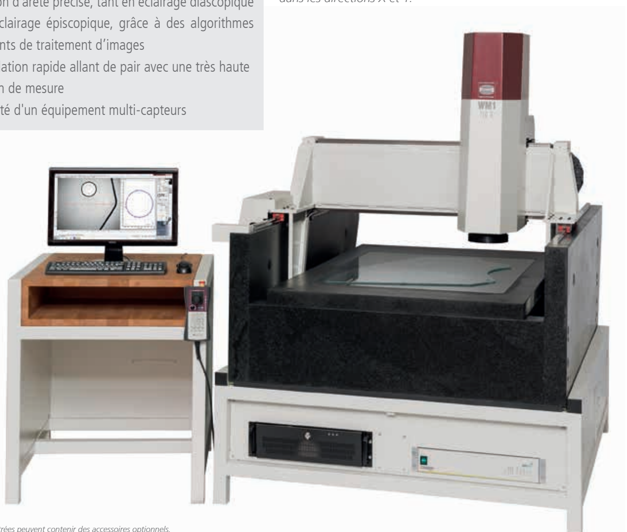
Éclairage diascopique à LED synchronisé avec le mouvement de la caméra dans les directions X et Y.
