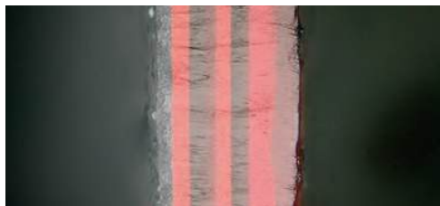
Coupe transversale de la peinture automobile 500X
