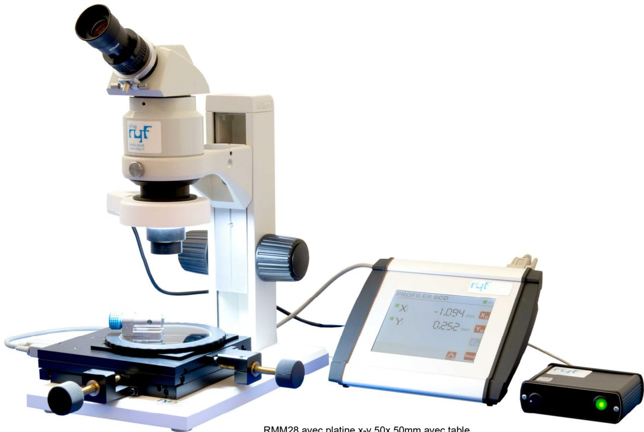
RMM28 avec platine x-y 50x 50mm avec table tournante 360°, échelles numériques incorporé à 0-50mm et en option oculaire goniomètre optique pour mesurer les angles /10 minutes
