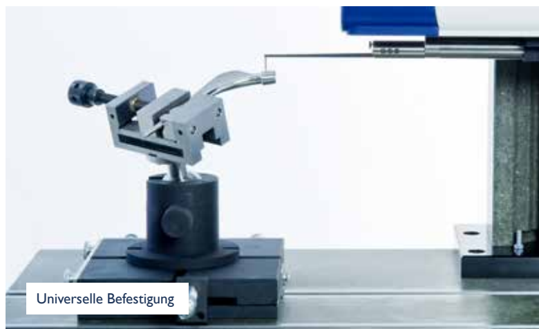
Radien mit rechtwinklig messenden Tastsystem
