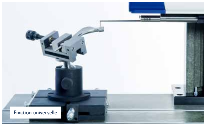
Mesure de rayon de raccordement avec le capteur à 90°
