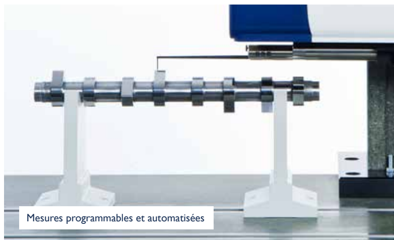
Analyse de la rugosité, de l'ondulation et du profil primaire
