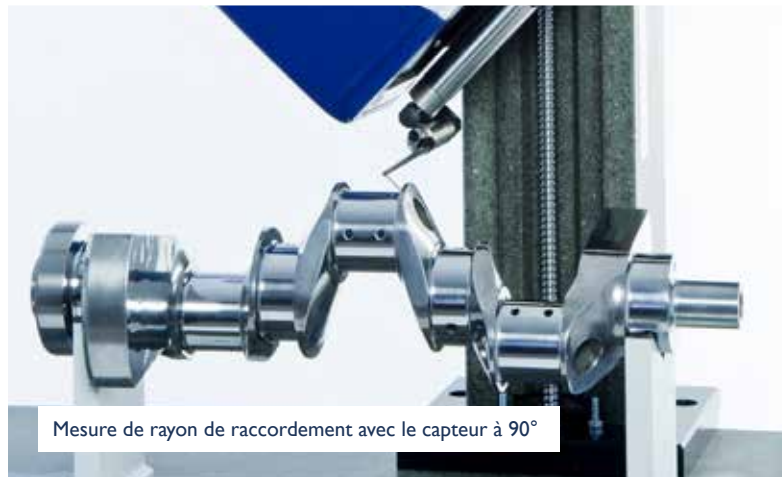
Analyse de la rugosité, de l'ondulation et du profil primaire
