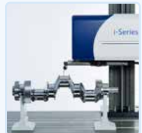
Rayons de flanc de raccord et comparaison DXF
