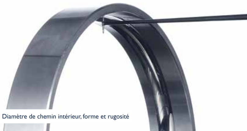
Mesure inverse pour analyse PCD de même que la forme et des dimensions des pistes gothiques
