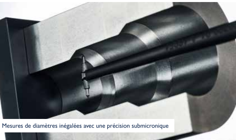
Diamètre de chemin intérieur, forme et rugosité
