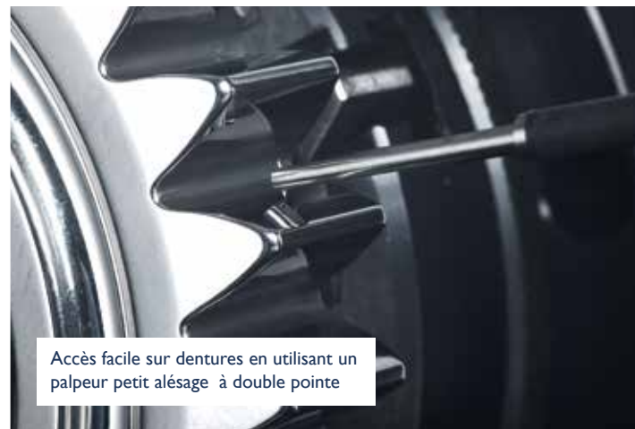
Mesure inverse pour analyse PCD de même que la forme et des dimensions des pistes gothiques
