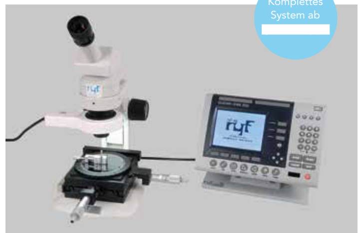
RMM30.2 mit 6,5x Zoomobjektiv, 50mm x 50mm Tisch ; Aufsattisch 360° drehbar, QC200 Messrechner, NKL18 Ringlicht und Durchlicht.
